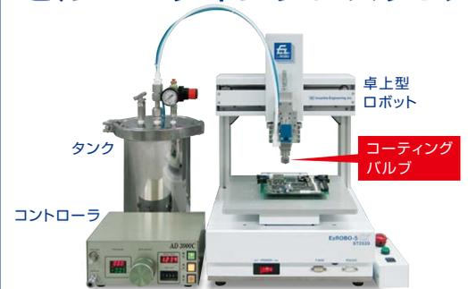
卓上型ロボットEzROBOに搭載することで安価でより確実な自動化が可能です。
