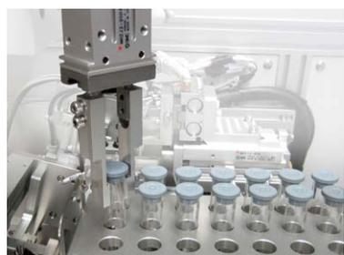
ロボットアームによる試料自動搬送。キャップ自動開閉
