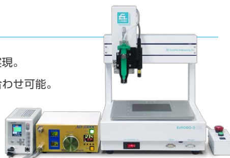
レンズ部品へのUV接着剤塗布・硬化
