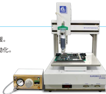
プリント基板へのハンダ付け(点塗布)
