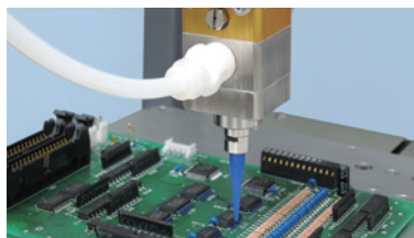
基板上的IC端子に防湿剤を塗布
